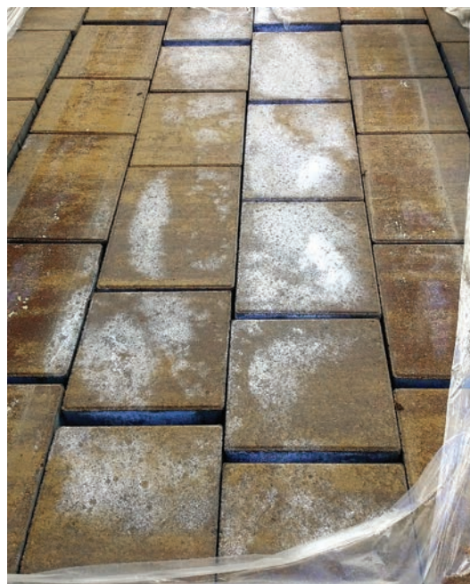
Рис. 4. Усугубление процесса высолообразования внутри паллет с продукцией.
