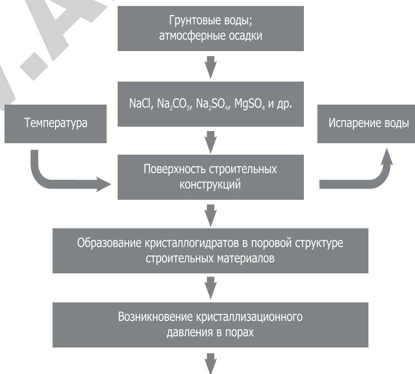
Рис.1. Принципиальная схема образования высолов.
